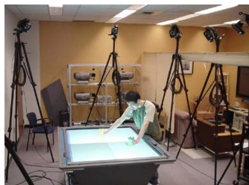
図 2: Tabletop Tangible User Interface の動作環境
